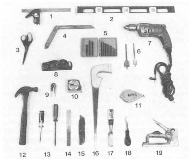
Bild 1 — Mindest-Werkzeug-Satz: (1) verstellbarer Anschlagwinkel; (2) Wasserwaage; (3) Schere; (4) Schmiegenstock; (5) Bohrersatz; (6) Zentrumsbohrer; (7) Elektrische Bohrmaschine; (8) Putzhobel; (9) Zirkel; (10) Maßband; (11) Anreißschnur; (12) Latthammer; (13) Schraubenzieher; (14) Raspel; (15) Teppichmesser; (16) Holzstichsäge; (17) Stecheisen; (18) Krampenzieher; (19) Klammer-Pistole
